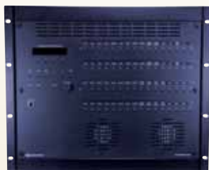
CEN-RGBHV32X32V Широкополосный RGB матричный коммутатор 32x32
